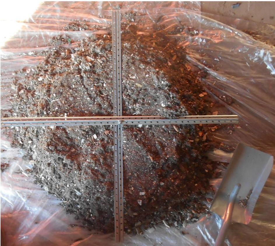
Tragbares Sieb zur Absiebung der physikalisch kleinsten nichtmetallischen mechanischen Behandlungsfraction, die bei einer Partikelgröße von über 5 mm entsteht:
